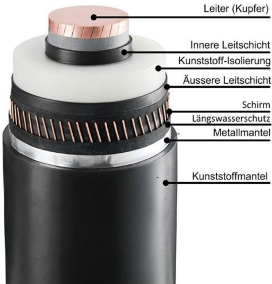
Abb. 3-3: Beispielhafter Kabelaufbau (Quelle: Broschüre Hochspannungskabel von ABB, Stand 01/2015)
